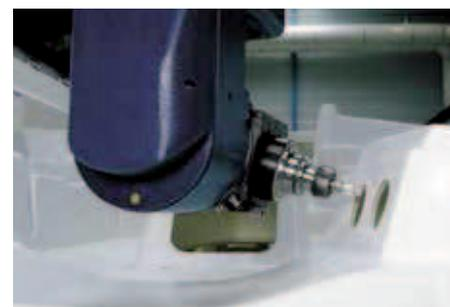
La coperta delle nostre barche è realizzata con sistema ad iniezione Prisma Process®. La nostra carpenteria viene lavorata con macchine tagliatrici digitali. La coperta è interamente preparata per la catena di produzione da macchine digitali di taglio e di trapanatura.
